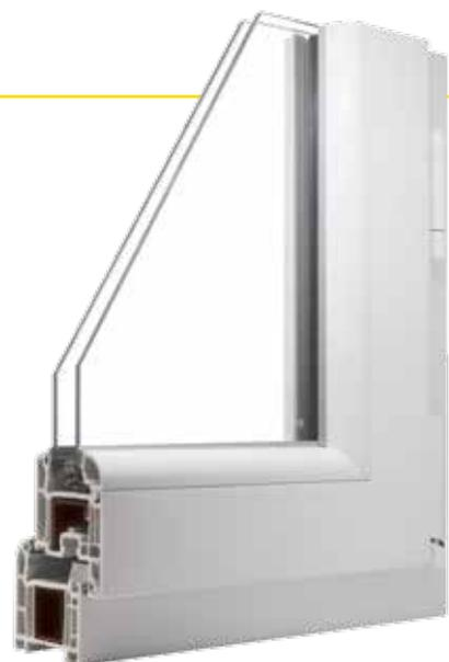
►► Profili Veka in classe A (classe più alta secondo la norma EN12608) e la ricca dotazione serie con struttura a 5 camere e vetri selettivi con gas Argon danno vita ad un infisso estremamente isolante.
