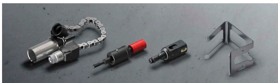
Il set utensili per l'inserto di presa filettato con collegamento a pressare comprende tutti i componenti necessari per realizzare derivazioni in installazioni già esistenti: guida di centraggio, fresa a tazza, utensile di trazione per pressatrice e supporto di posizionamento.
