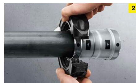
2 Per pressare i raccordi Megapress a partire da 1\frac{1}{4} si usano esclusivamente le corone con ganascia ad accoppiamento snodato. Nelle dimensioni più piccole, comprese tra \frac{3}{8} e 1 pollice, si può scegliere tra ganasce o corone con ganascia ad accoppiamento snodato.
