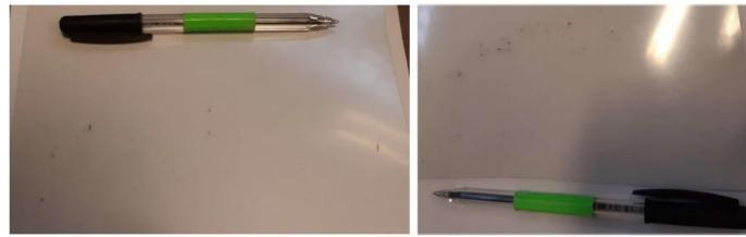
Figura 1. Esempio di puntinatura nera
