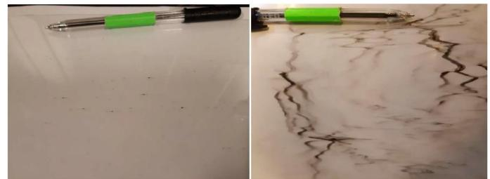
Figura 2 Esempio di puntinatura nera a sinistra e flussata nera a destra
