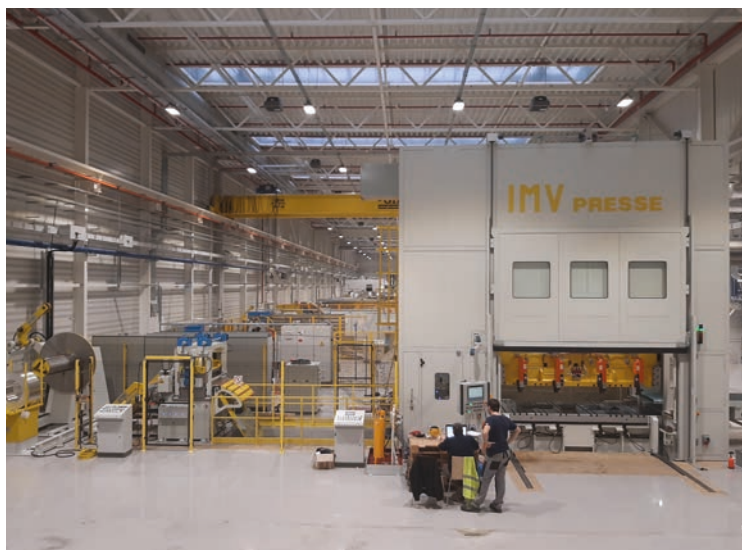
Pressa meccanica DM80L4 con cinematismo a ginocchia Lever4
