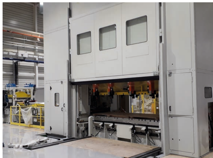
Fronte pressa e cabina insonorizzazione
