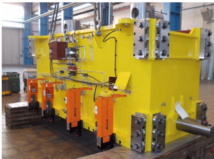
Slitta con guide a rullo di precisione
