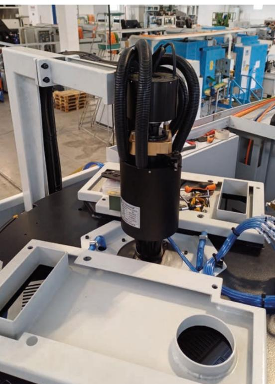
La distribuzione di segnali e corrente al 4° e 5° asse avviene tramite due distributori: uno Ethernet e uno per la corrente
