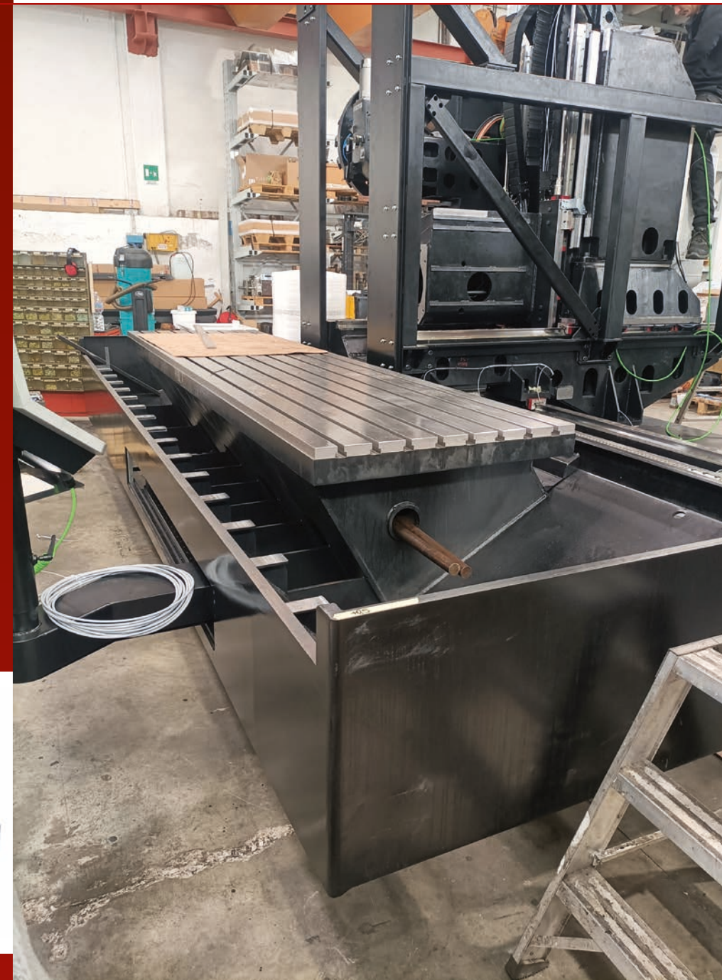
Il basamento in acciaio elettrosaldato assicura rigidità e stabilità
