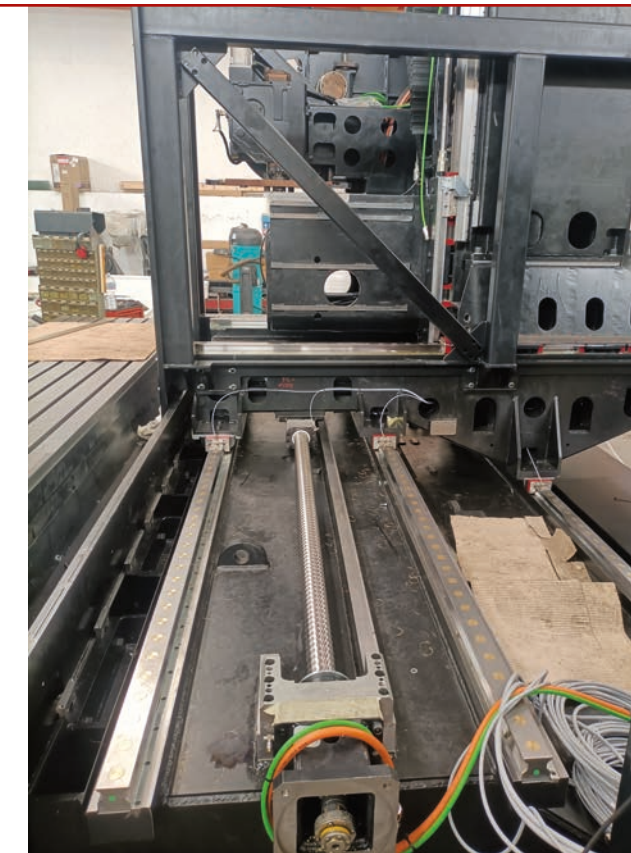
L'asse X scorre su tre guide a ricircolo di rulli, una delle quali è posizionata più in basso rispetto alle altre
