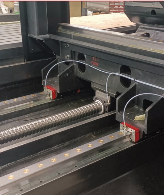
Tutti gli assi sono comandati motori Direct Drive accoppiati a viti a ricircolo di sfere
