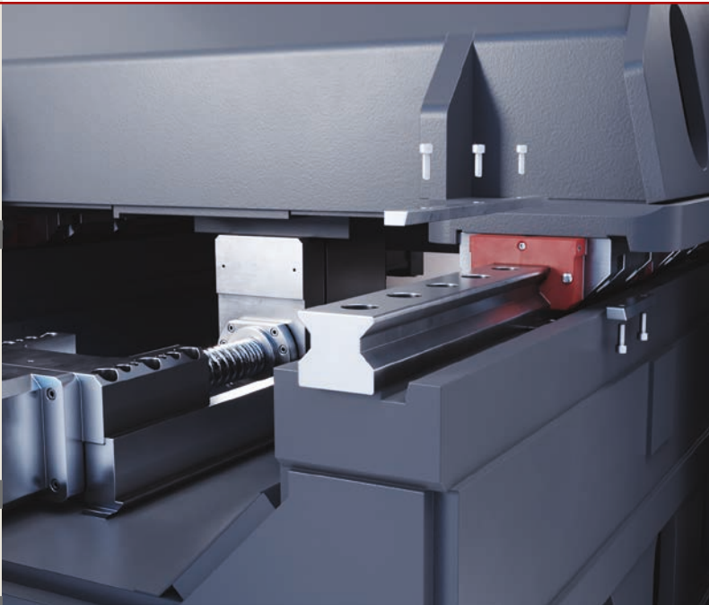
Il particolare sistema di bloccaggio delle guide assicura il mantenimento della geometria della macchina
