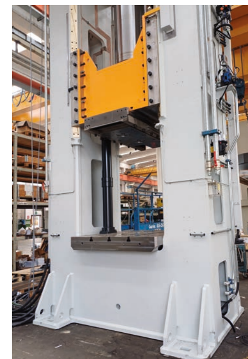
Struttura monolitica in carpenteria elettrosaldata
