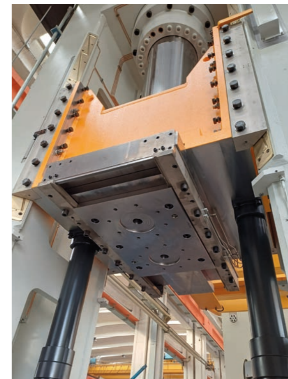
Cassetto portastampi superiore a due posizioni
