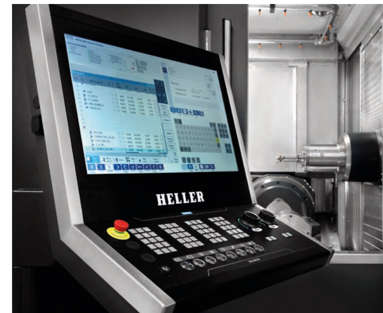
HF 5500 è gestito tramite CN Siemens Sinumerik ONE con interfaccia HMI sviluppata da Heller
