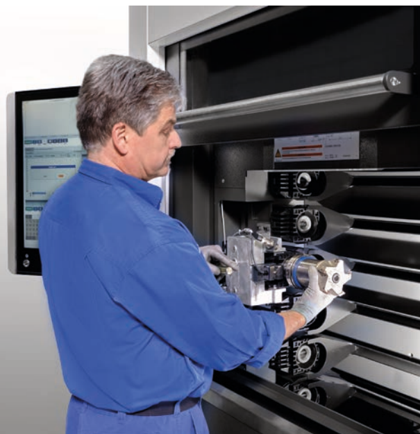
In prossimità della postazione per l'allestimento degli utensili è possibile collocare un secondo terminale di comando del centro di lavoro
