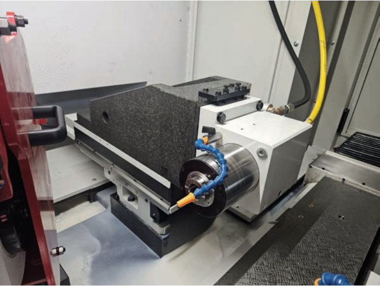
L'unità da interni è equipaggiata con elettromandri corpo diametro 100 mm o 120 mm
