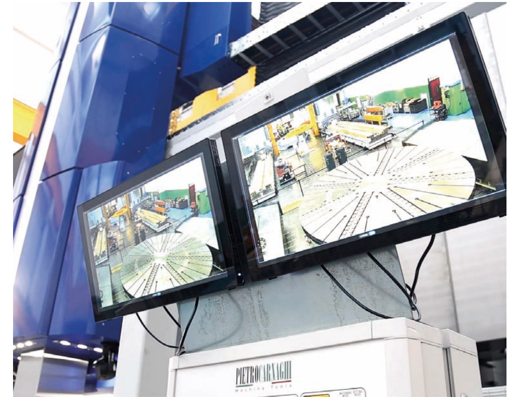
Le telecamere consentono all'operatore di controllare la zona di lavoro in totale sicurezza
