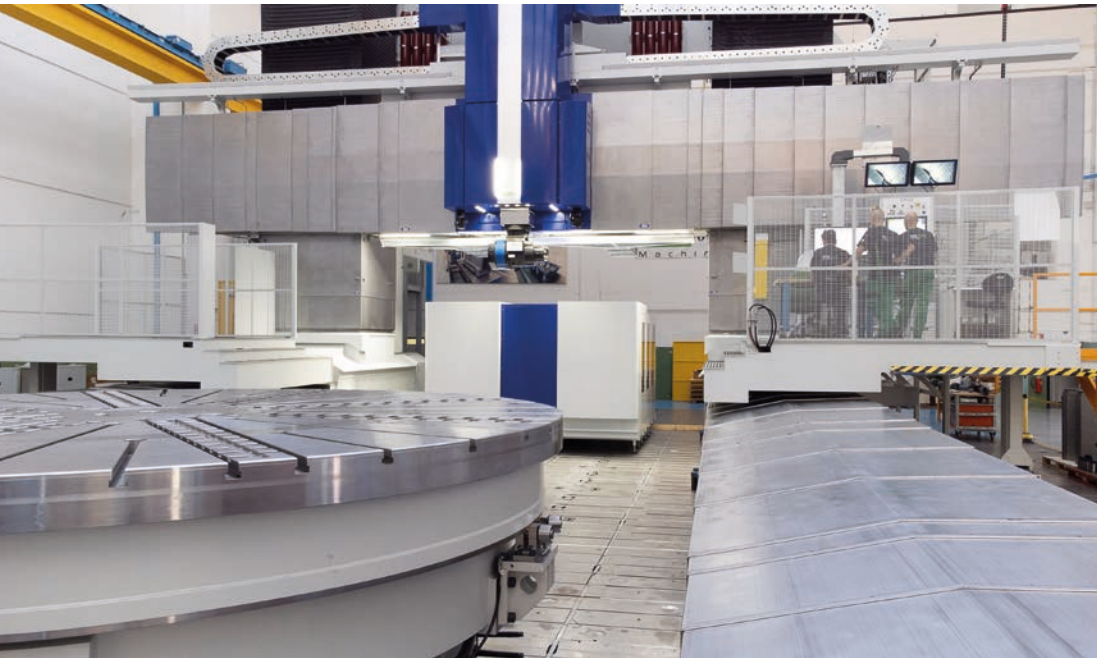
La tavola di tornitura/fresatura è movimentata da due motori da 58 kW l'uno
