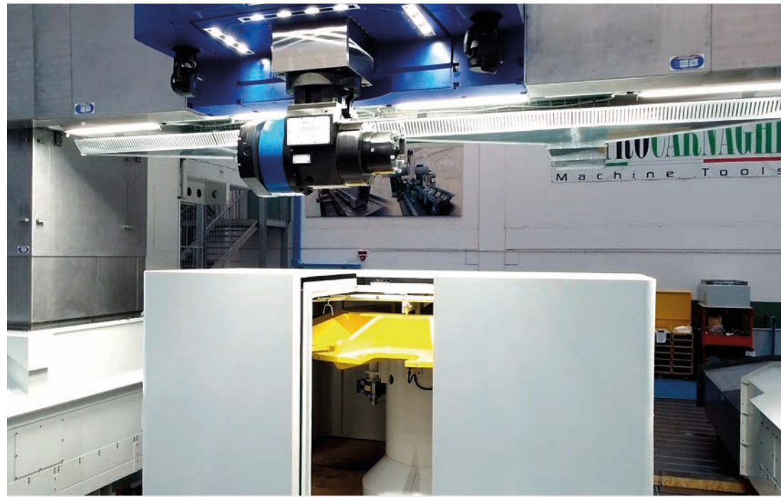
UniMill 60 T è completato con un magazzino teste a dieci posizioni
