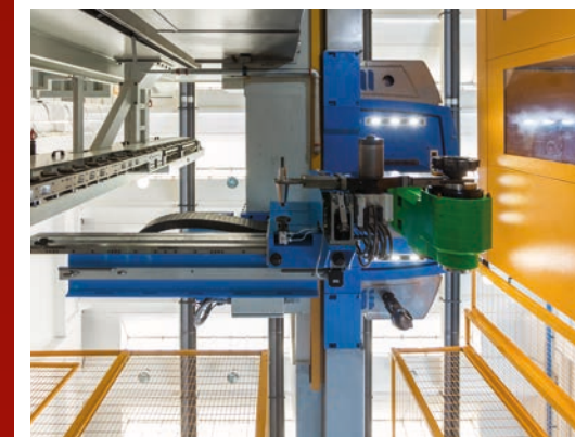
Cambio utensile e cambio accessori sono automatici, per garantire un'elevata produttività
