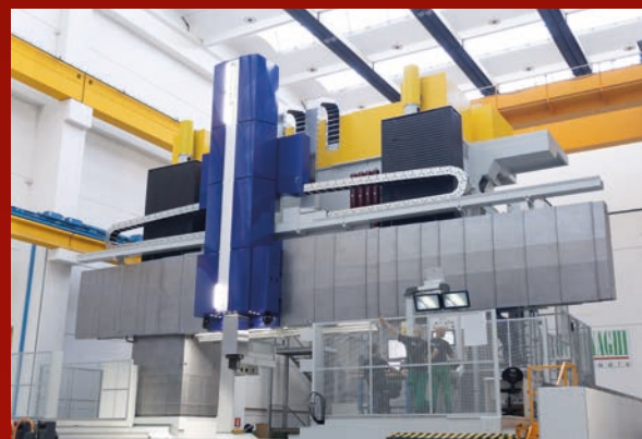
L'architettura gantry permette una grande versatilità di utilizzo
