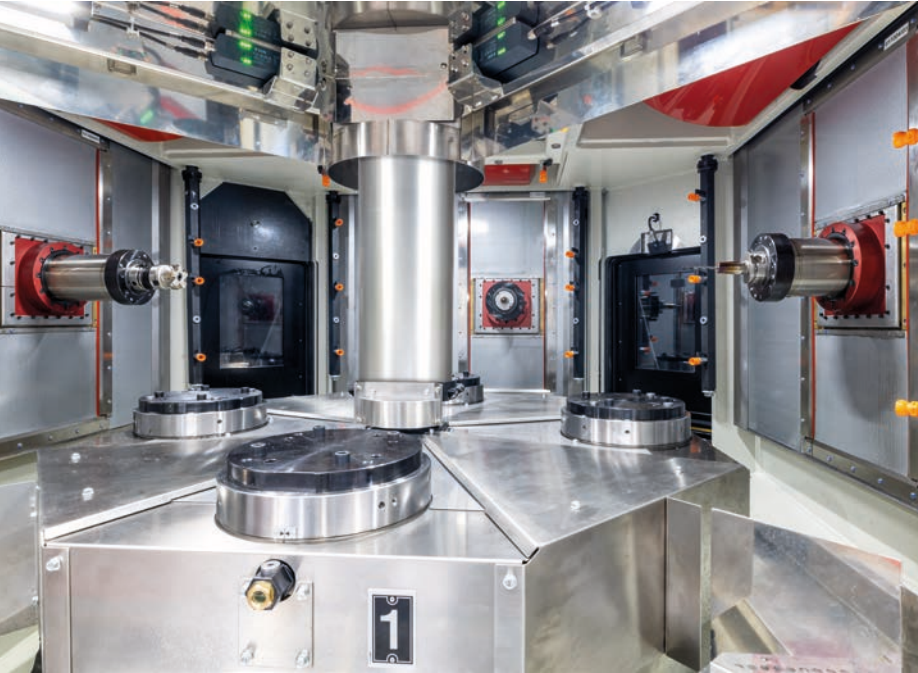
I tre mandrini totalmente indipendenti assicurano un'elevata ripetibilità della precisione sull'intero lotto
