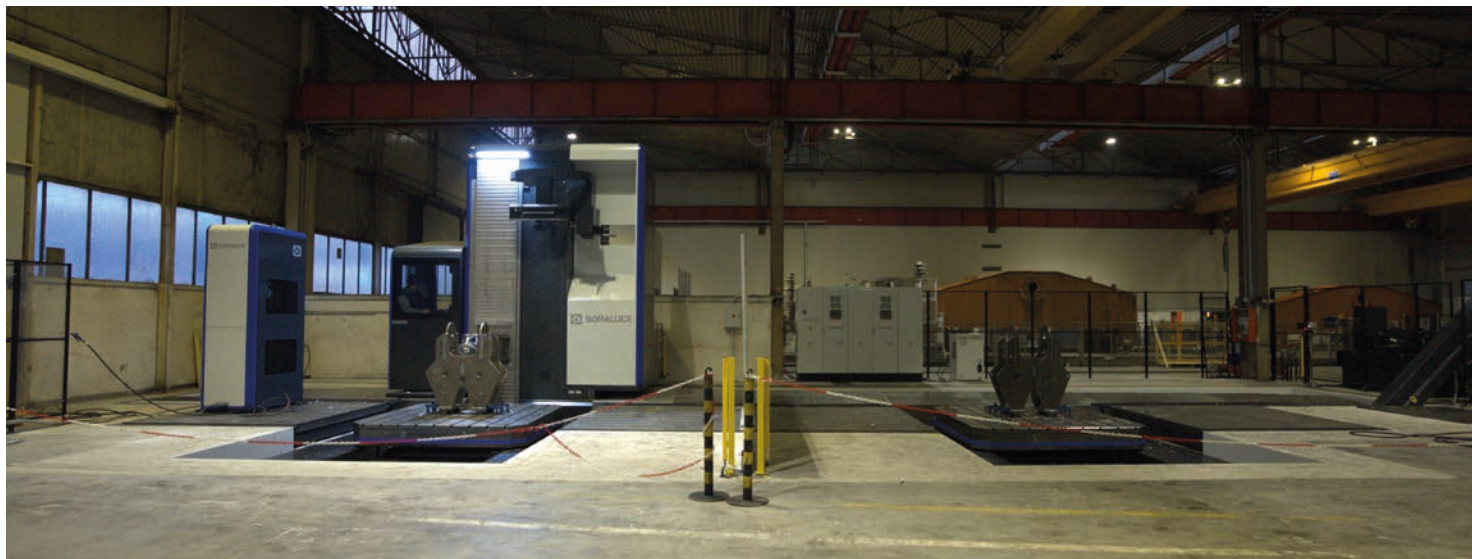
La fresatrice SORALUCE FP160 installata presso Cimolai è dotata di doppia tavola rototraslante
